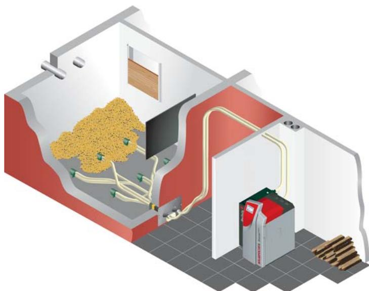
Gracias a la supresión del suelo inclinado, el sistema de aspiración con sondas de aspiración permite aprovechar al máximo el espacio. La disposición individual de las sondas de aspiración permite utilizar almacenes con mucho rincones o anchos, o incluso dos almacenes separados. La unidad de conmutación automática de sondas de aspiración permite conectar hasta 6 sondas de aspiración, mientras que la versión manual permite conectar hasta 4.
