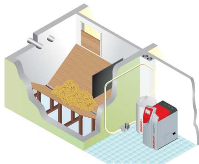
El sistema de aspiración con sinfín de aspiración está diseñado para salas grandes y largas. Gracias al uso de un suelo inclinado, el almacén puede vaciarse completamente. El sinfín puede medir de 2 a 6 m de longitud. Al final del sinfín, los pellets se transportan hasta la caldera de la manera habitual con un sistema de aspiración.
