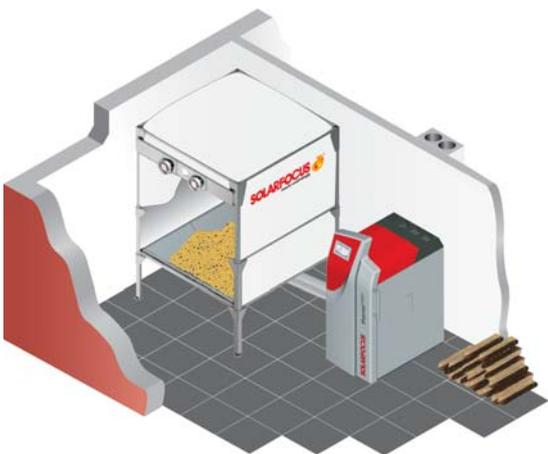
Si no quiere o no puede utilizarse un almacén clásico, puede utilizarse un contenedor de pellets. Los contenedores de pellets no requieren grandes obras y son especialmente útiles para los lugares con humedad. Los contenedores de pellets pueden estar hechos de acero galvanizado o de tejido. En la variante con sinfín de transporte directo, los pellets se suministran a la caldera directamente por medio de un inyector.
