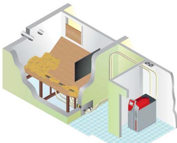
El sistema de aspiración con sondas de aspiración y suelo inclinado es adecuado para los almacenes especialmente grandes. Si un almacén es tan grande que no se puede vaciar completamente con las sondas de aspiración, puede instalarse un suelo inclinado para facilitar el vaciado.
