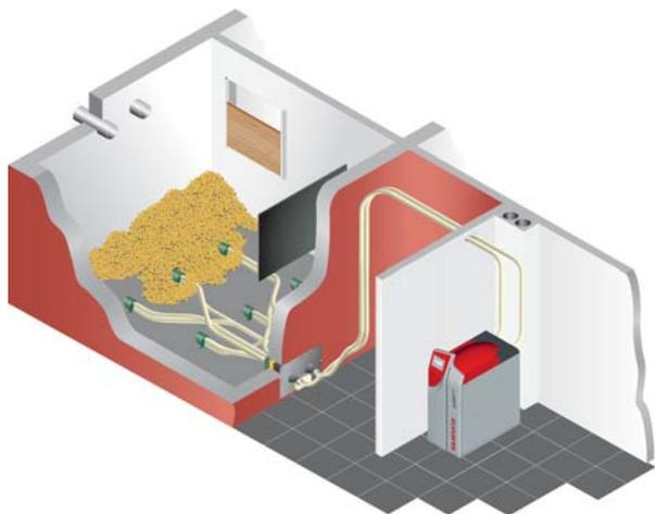
Gracias a la supresión del suelo inclinado, el sistema de aspiración con sondas de aspiración permite aprovechar al máximo el espacio. La disposición individual de las sondas de aspiración permite utilizar almacenes con mucho rincones o anchos, o incluso dos almacenes se parados. La unidad de conmutación automática de sondas de aspiración permite conectar hasta 6 sondas de aspiración, mientras que la versión automática permite conectar hasta 4.
