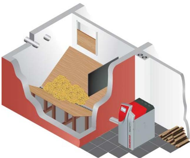
El sinfín de transporte resulta especialmente adecuado cuando el almacén está situado justo al lado de la sala de calderas. Gracias al uso de un suelo inclinado, el almacén puede vaciarse completamente. El sinfín puede medir de 2 a 6 m de longitud.
