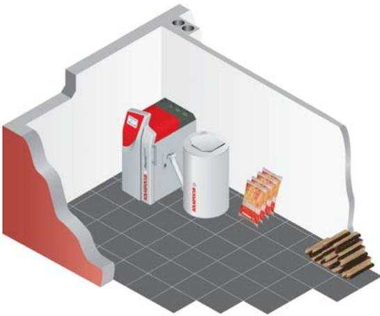
Esta solución es la versión más económica. El depósito de reserva se llena manualmente a través de una tapa y puede instalarse a la derecha o a la izquierda, según se prefiera. El depósito de reserva tiene 250 litros de capacidad. En caso necesario, al depósito de reserva de carga manual se le puede añadir una descarga de aspiración automática.
