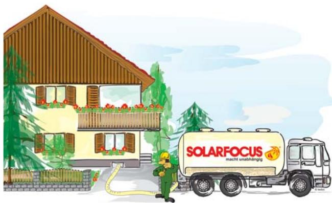
Cada metro de manguera y cada curva provocan desgaste fino durante el proceso de introducción. En algunos casos, realizar el tendido de la tubería dentro del edificio puede ayudar a reducir considerablemente la longitud de manguera necesaria para cargar el almacén.
