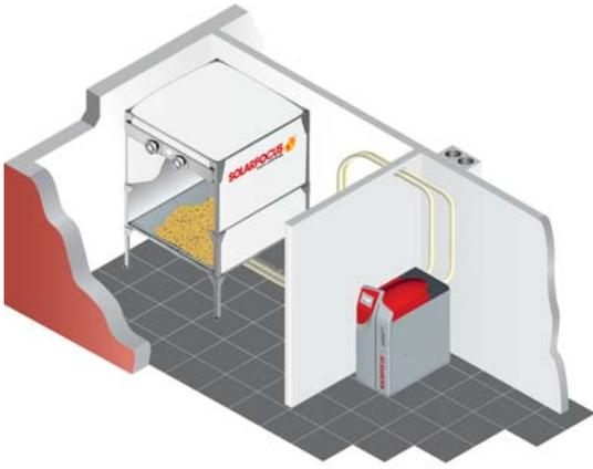
Si no quiere o no puede utilizarse un almacén clásico, puede utilizarse un contenedor de pellets. Los contenedores de pellets no requieren grandes obras y son especialmente útiles para los lugares con humedad. Los contenedores de pellets pueden estar hechos de acero galvanizado o de tejido.
