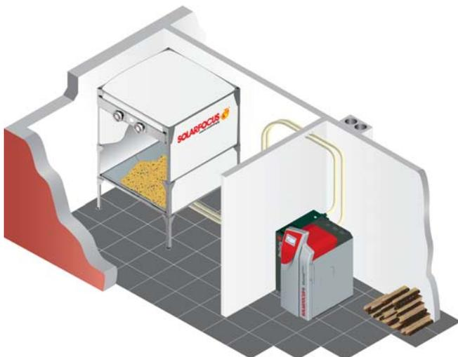
Si no quiere o no puede utilizarse un almacén clásico, puede utilizarse un contenedor de pellets. Los contenedores de pellets no requieren grandes obras y son especialmente útiles para los lugares con humedad. Los contenedores de pellets pueden estar hechos de acero galvanizado o de tejido. En la variante con sistema de aspiración, los pellets se transportan a un depósito de reserva y, desde ahí, se suministran a la caldera.
