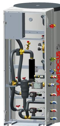
Der **hydro<sup>tower</sup> easy** ist ein Doppelspeicher mit 255-Liter-Trinkwasser- und 255-Liter-Puffervolumen mit integriertem Hydraulikmodul. Der emaillierte Systemspeicher mit Hydraulikeinheit bildet zusammen mit der Wärmepumpe **vamp<sup>air</sup> PRO** ein kompaktes Heiz- und Kühlsystem für Flächenheizungen. Für zusätzlichen Korrosionsschutz sorgt eine integrierte Magnesium-Stabanode.
