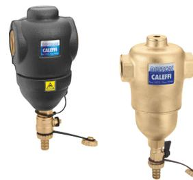
Der Schmutz- und Schlammabscheider dient der Absonderung von Verunreinigungen aus Sand- und Schlammpartikeln in geschlossenen Kreisläufen von Anlagen. Der maximale Betriebsdruck beträgt 10 bar, die maximale Betriebstemperatur 110°C.
