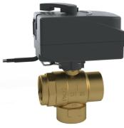
Das LK 527 MultiZone ist ein motorisierter 2- bzw. 3-Wege Kugelhahn, geeignet zur Anwendung in Heiz-, Kühl- und Brauchwassersystemen. Bei den Gewinden handelt es sich um ein drei RP-Außengewinde 6/4". Der maximale Arbeitsdruck beträgt 3,2 MPa, die maximale Arbeitstemperatur 110°C.
