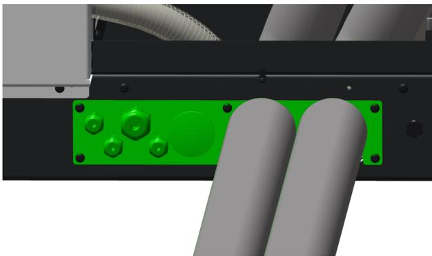
Verbindungsleitung und Kabelschutzrohr müssen diffusionsdicht und wärmeisolierend abgedichtet und bauseits vor Bewitterung geschützt werden.
