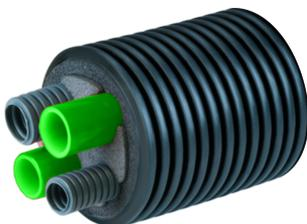
Bei Primärkreis-Anschluss an der Unterseite der Wärmepumpe wird die Verlegung eines Wärmepumpenrohres im Erdreich empfohlen. Dieses muss durch das Fundament geleitet werden und enthält die Verrohrung für Buskabel, Stromkabel und Vor- und Rücklauf sowie die entsprechende Isolierung.
