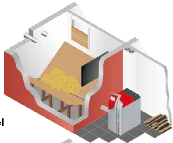
Pelletbox 350 liter handmatig vulbaar met zuigsonde
