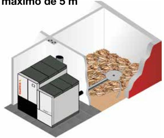
**Descarga directa de combustible con agitador articulado de diámetro máximo de 6 m con transportadora de llenado**
