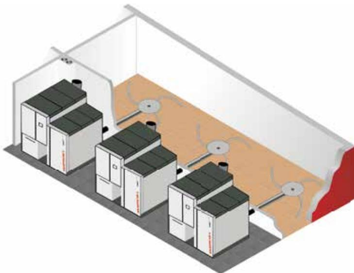
Mit Hilfe der Kaskadenschaltung können bis zu 6 Kessel miteinander verbunden und bedarfsgerecht geregelt werden. Eine Gesamtleistung von bis zu 1,8 MW bei Verfeuerung mit Pellets ist somit möglich.
