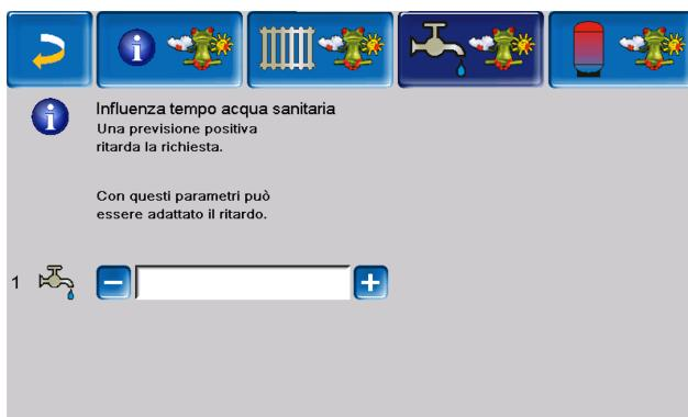
Una previsione del tempo positiva ritarda l'avvio del bruciatore in caso di una richiesta fatta dal bollitore ACS/zona ACS. In questo modo l'impianto solare termico ha la possibilità e il tempo di caricare il bollitore in un secondo momento senza che la caldaia debba avviarsi.
