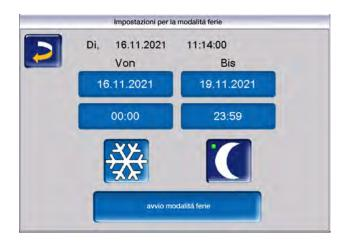
attiva la funzione *antigelo* per il circuito di riscaldamento per il periodo della modalità ferie impostato.
