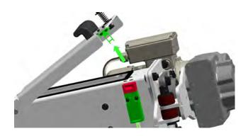
Questo interruttore di sicurezza assicura che l'alimentazione del motore della coclea venga interrotta quando il coperchio dello scivolo di scarico viene aperto.
