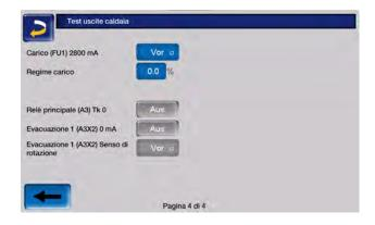
**Nota -** Il test di uscita può essere aperto solo quando la caldaia è spenta o è in *standby*.
