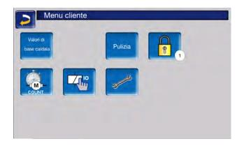
Questa funzione è una protezione contro modifiche non autorizzate dei parametri di regolazione. Con la funzione Blocco utente attivata i parametri delle schermate vengono visualizzati, ma non sono modificabili.
