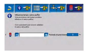
Se la funzione non consente di caricare completamente il puffer con il bruciatore a causa delle buone previsioni del tempo, nel menu principale del puffer viene visualizzato il simbolo della rana meteo.
