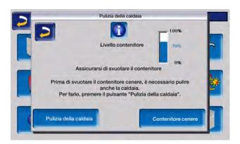
La caldaia deve essere pulita con la cadenza specificata prima di svuotare il contenitore cenere.
