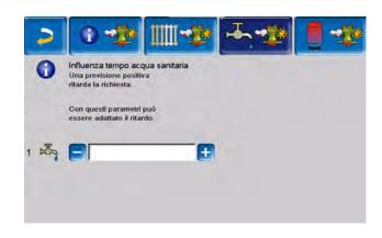
Una previsione del tempo positiva ritarda l'avvio del bruciatore in caso di una richiesta fatta dal bollitore ACS/zona ACS. In questo modo l'impianto solare termico ha la possibilità e il tempo di caricare il bollitore in un secondo momento senza che la caldaia debba avviarsi.
