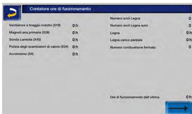
Le ore di funzionamento delle singole uscite sono elencate in questo menu. Questi vengono conteggiati solo se l'uscita corrispondente è accesa.
