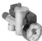
Installer l'unité de sécurité de la chaudière dans la conduite d'entrée de la chaudière au point le plus haut et au plus près de la chaudière. Position de montage : à la verticale, voir illustration.
