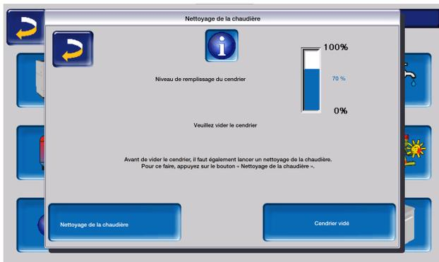
Un nettoyage de la chaudière doit être effectué selon l'intervalle indiqué avant de vider le cendrier.
