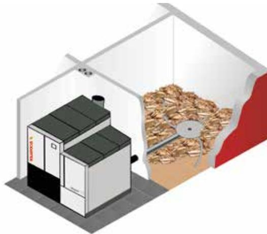
**Extraction directe avec agitateur à bras articulé jusqu'à Ø 6 m avec vis sans fin de chargement**
