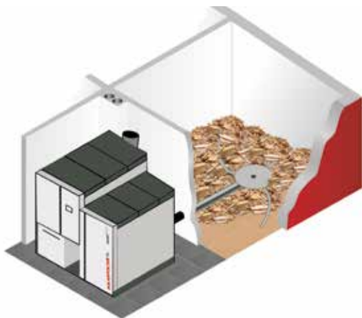
Extraction directe avec agitateur à lames jusqu'à Ø 4,5 m ou avec agitateur à bras coudé jusqu'à Ø 6,0 m
