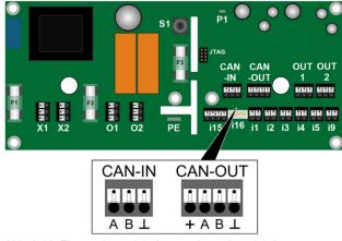
Abb. 2-42: Electronic module (type universal module )
