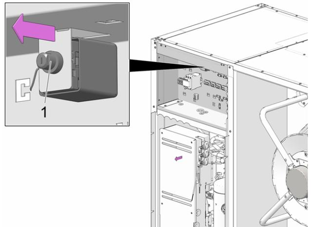
Abb. 2-56: Overtemperature reset
