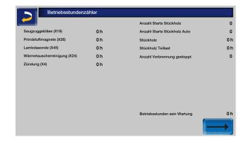
In diesem Menü werden die Betriebsstunden der einzelnen Ausgänge aufgelistet. Diese werden nur dann gezählt, wenn der entsprechende Ausgang eingeschaltet ist.
