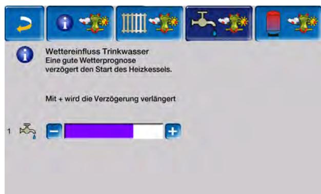
Eine gute Wetterprognose verzögert den Start des Brenners bei einer Anforderung durch den Trinkwasserspeicher/Trinkwasserbereich. Somit wird der thermischen Solaranlage die Möglichkeit und Zeit gegeben, den Speicher später aufzuladen, ohne dass der Kessel starten muss.
