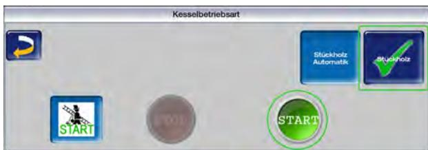
Die ersten Möglichkeiten dienen der Wahl des Brennstoffes. In diesem Fall ist die Verwendung von Stückholz aktiv.
