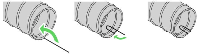
**ACHTUNG** - Die Metalllitze muss dauerhaft einen elektrisch leitfähigen Kontakt zum Anschlussrohr haben.
