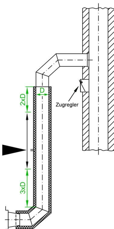
Ist die Umsetzung dieser Vorgaben nicht möglich, dann muss die Messstelle nach einer Beruhigungsstrecke, also nach dem längsten gerade laufenden Teilstück des Rohres, angebracht werden. Die Ausrichtung des Rohres spielt in diesem Fall keine Rolle.
