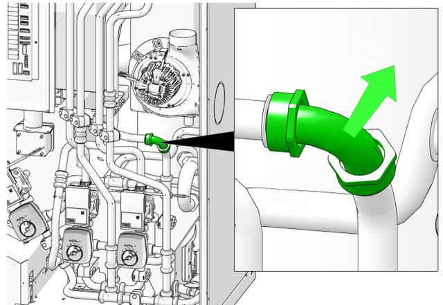
► Montieren Sie an dieser Stelle das Umschaltventil und das Bypassrohr.
