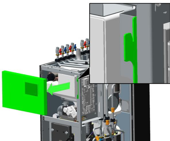
Achten Sie dabei darauf, dass die Kabel am Display keinen Schaden nehmen. Entfernen Sie diese bei Bedarf.
