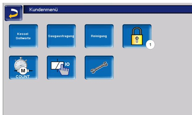
Diese Funktion dient zum Schutz vor unbefugter Änderung der Regelungsparameter. Bei aktiver Benutzersperre werden die Parameter der einzelnen Masken angezeigt, können aber nicht geändert werden.
