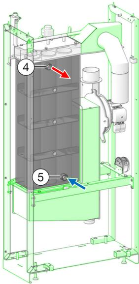
Das vom Heizungsrücklauf kommende Wasser wird beim untenliegenden Anschluss **4** in den Wärmetauscher geleitet, durch das Abgas erwärmt und fließt bei Anschluss **5** weiter zu Rücklaufmischer und Rücklaufanhebungspumpe des Kessels.
