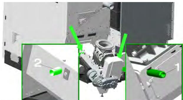
Wird am Temperaturfühler in der Tauchhülse **1** bei Direktaustragung eine Temperatur von 50°C, bei Fallrohraustragung von 95°C überschritten, so öffnet das Ventil und flutet durch das Anschlussrohr **2** den Einschubkanal mit Wasser.
