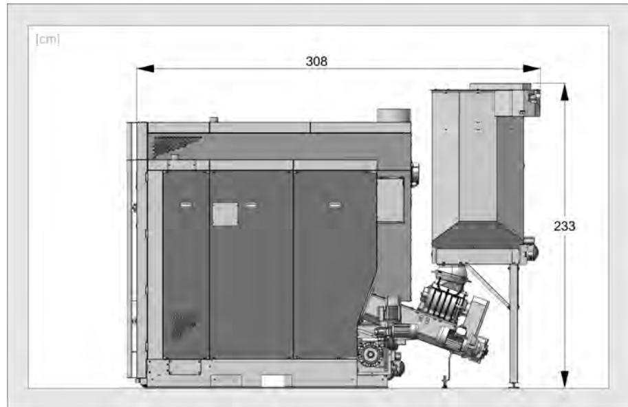
Die folgenden Abbildungen zeigen die Möglichkeiten für den Kessel **maximus L** mit den externen Ascheaustragungssystemen Normmülltonne und Kippbehälter (beide optional).
