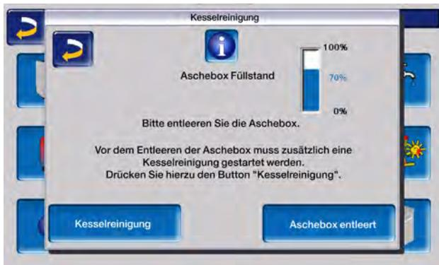
Vor der Entleerung der Aschebox ist im angegebenen Intervall eine Kesselreinigung durchzuführen.
