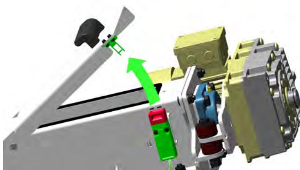
Dieser Sicherheitsschalter gewährleistet, dass beim Öffnen der Austragungskanal-Abdeckung die Stromzufuhr zum Förderschneckenmotor unterbrochen wird.
