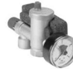
Die KSG in die Kessel-Vorlaufleitung einbauen, am höchsten Punkt der Leitung, möglichst nahe beim Kessel. Einbaulage: senkrecht, siehe Abbildung.
