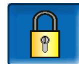
Diese Funktion dient zum Schutz vor unbefugter Änderung der Regelungsparameter. Bei aktiver Benutzersperre werden die Parameter der einzelnen Masken angezeigt, können aber nicht geändert werden.
