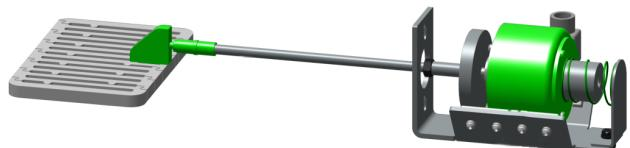
Der Motor überträgt mit dem Gestänge Vibrationen auf den Brennrost. Dadurch wird dieser von Ascherückständen befreit.
