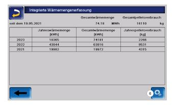
Der Pelletsverbrauch wird mit maximal 15% Abweichung angezeigt und dient gemeinsam mit dem Wirkungsgrad zur Berechnung der Wärmemenge.
