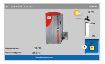
Die aktive Benutzersperre wird in den Masken durch ein Vorhängeschloss-Symbol 1 signalisiert.
