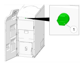
Ein Auslösen des STB wird am Display der Kesselregelung angezeigt.
