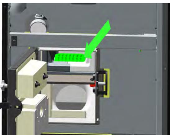
Bei fortgeschrittener Abnutzung des Brennrostes vergrößern sich die Zwischenräume im Rost. In der Folge fallen unvollständig verbrannte Pellets durch den Rost.
