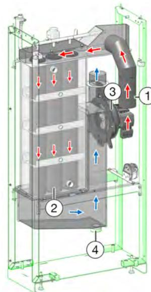
Das vom Kessel kommende Abgas strömt durch die Abgasleitung 1 weiter durch die Wärmetauscher-Rohre 2 und kühlt dort ab. In abgekühltem Zustand wird das Abgas durch das Saugzuggebläse 3 in den Kamin befördert. Das anfallende Kondensat wird durch den Abfluss 4 abgeleitet.
