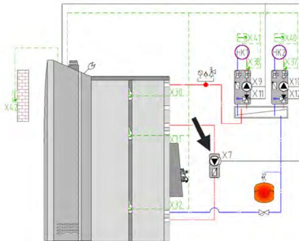
Die Regelung der Umwälzpumpe erfolgt mittels der Differenzkreis-Funktion am Kesselleistungsteil.
