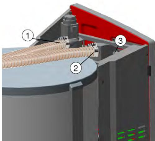
**ACHTUNG -** Die Metalllitze muss dauerhaft einen elektrisch leitfähigen Kontakt zum Anschlussrohr haben.
