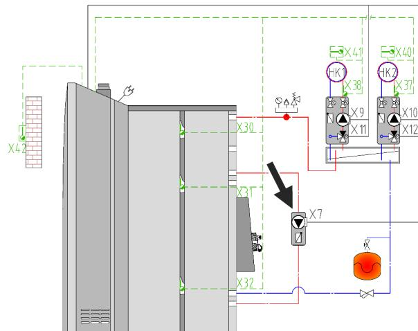
Die Regelung der Umwälzpumpe erfolgt mittels der Differenzkreis-Funktion am Kessel- leistungsteil.
