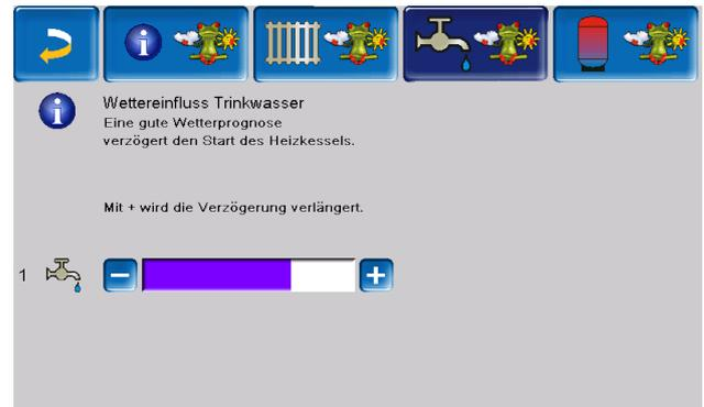
Eine gute Wetterprognose verzögert den Start des Brenners bei einer Anforderung durch den Trinkwasserspeicher/Trinkwasserbereich. Somit wird der thermischen Solaranlage die Möglichkeit und Zeit gegeben, den Speicher später aufzuladen, ohne dass der Kessel starten muss.
