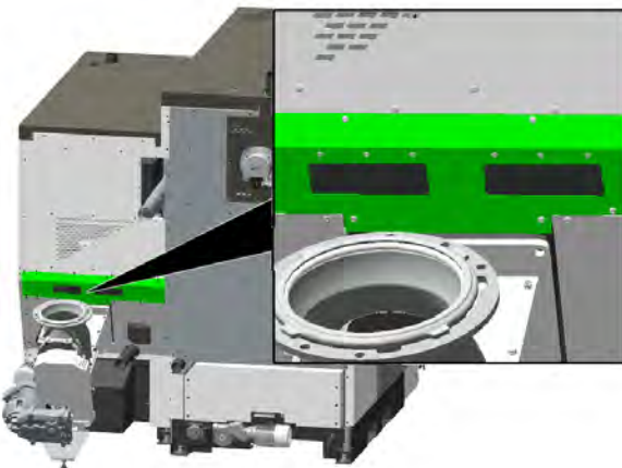
Brenner Rückseite: Kabelkanal 3
