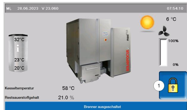
Die aktive Benutzersperre wird in den Masken durch ein Vorhängeschloss-Symbol 1 signalisiert.
