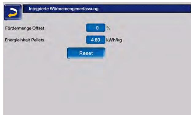
Hier kann der *Fördermenge Offset*, also der Unterschied zwischen angezeigtem und tatsächlichem Pelletsverbrauch ausgeglichen werden.
